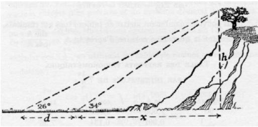
Dans l'exemple pris, les angles sont de  $34^\circ$  et  $26^\circ$ , la distance  $d$  mesurée est de 64 mètres. Calculer la hauteur  $h$  de la pente.
